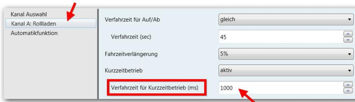
Die Länge der Verfahrzeit für Kurzzeitbetrieb, also wie lange ein Rollladen bei einer kurzen Tastenbetätigung fährt, kann in den Parametern eingestellt werden (nur wenn Kurzzeitbetrieb aktiviert wurde)
