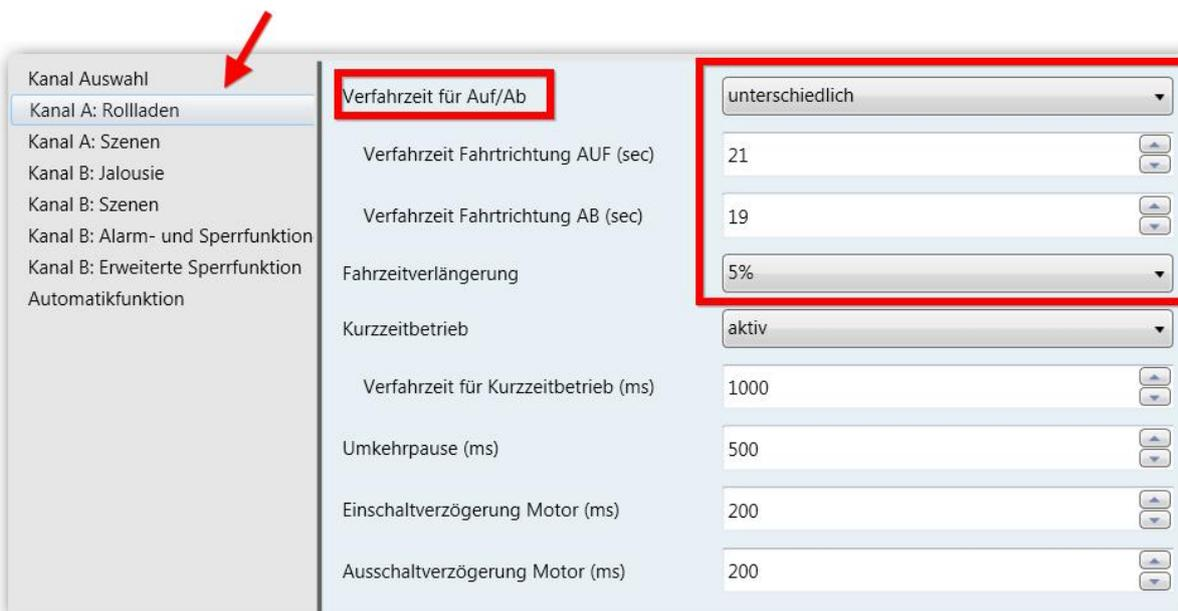
Für korrekte Ansteuerungen auf bestimmte Positionen (z.B. absolute Position) müssen die Verfahrzeiten für jeden Antrieb genau ermittelt und angegeben werden
