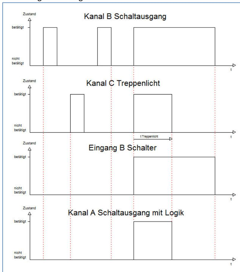
Der Schaltausgang A bleibt nur solange aktiv, wie die Logikfunktion auch erfüllt ist. Sobald nicht mehr alle 3 Elemente eine logische 1 ausgeben, wie hier bei Ablauf der Treppenlichtzeit, wird der Kanal A abgeschaltet.
