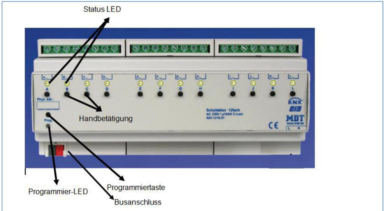
Abbildung 7: Übersicht Hardwaremodul Schaltaktor (Bsp.: Schaltaktor AKI 1216.01)
