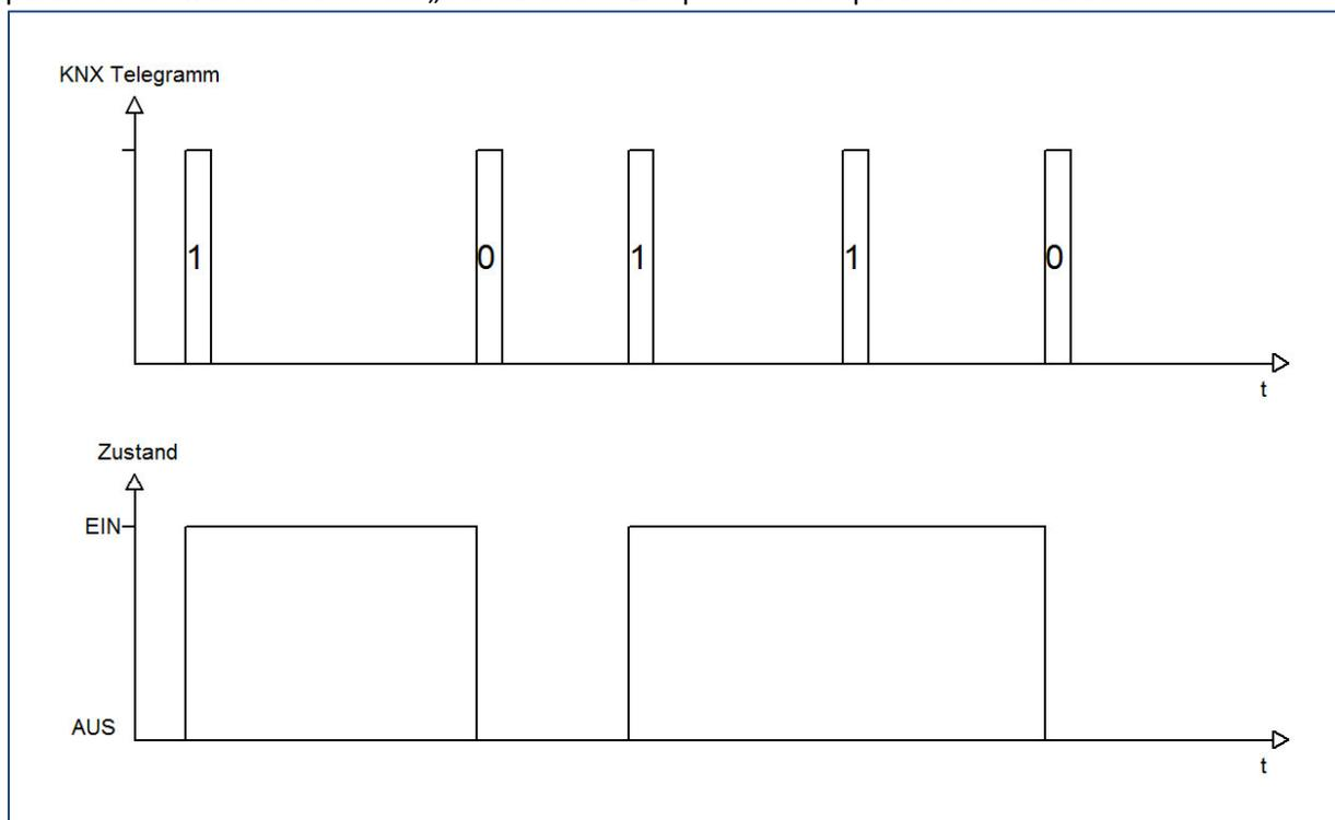
Das KNX-Telegramm zeigt, welcher Wert dem Sperrobject gesendet wurden. Auf die Aktivierung (=Sendung einer logischen „1“) reagiert der dazugehörige Kanal mit dem Einschalten dieses Kanals. Wird der Sperrvorgang deaktiviert (=Sendung einer logischen „0“) so wird der dazugehörige Kanal wieder ausgeschaltet.
