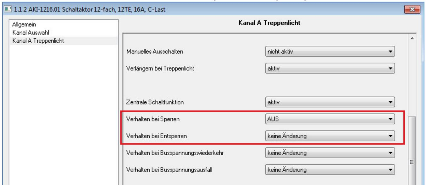
Die Ansteuerung der Dauerfunktion erfolgt, wie in den Einstellungen erkenntlich über die Sperrobjekte. Wird dem Sperrobject ein AN-Telegramm gesendet, so schaltet dieses, je nach Parametrierung, die Dauer EIN oder die Dauer AUS Funktion ein und die Treppenlichtfunktion damit außer Betrieb.
