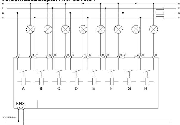
Hinweis: AKI/AKS 08/12: Versorgungsspannung 230VAC, ab Q3 über KNX Bus (Netzlemme entfällt)
